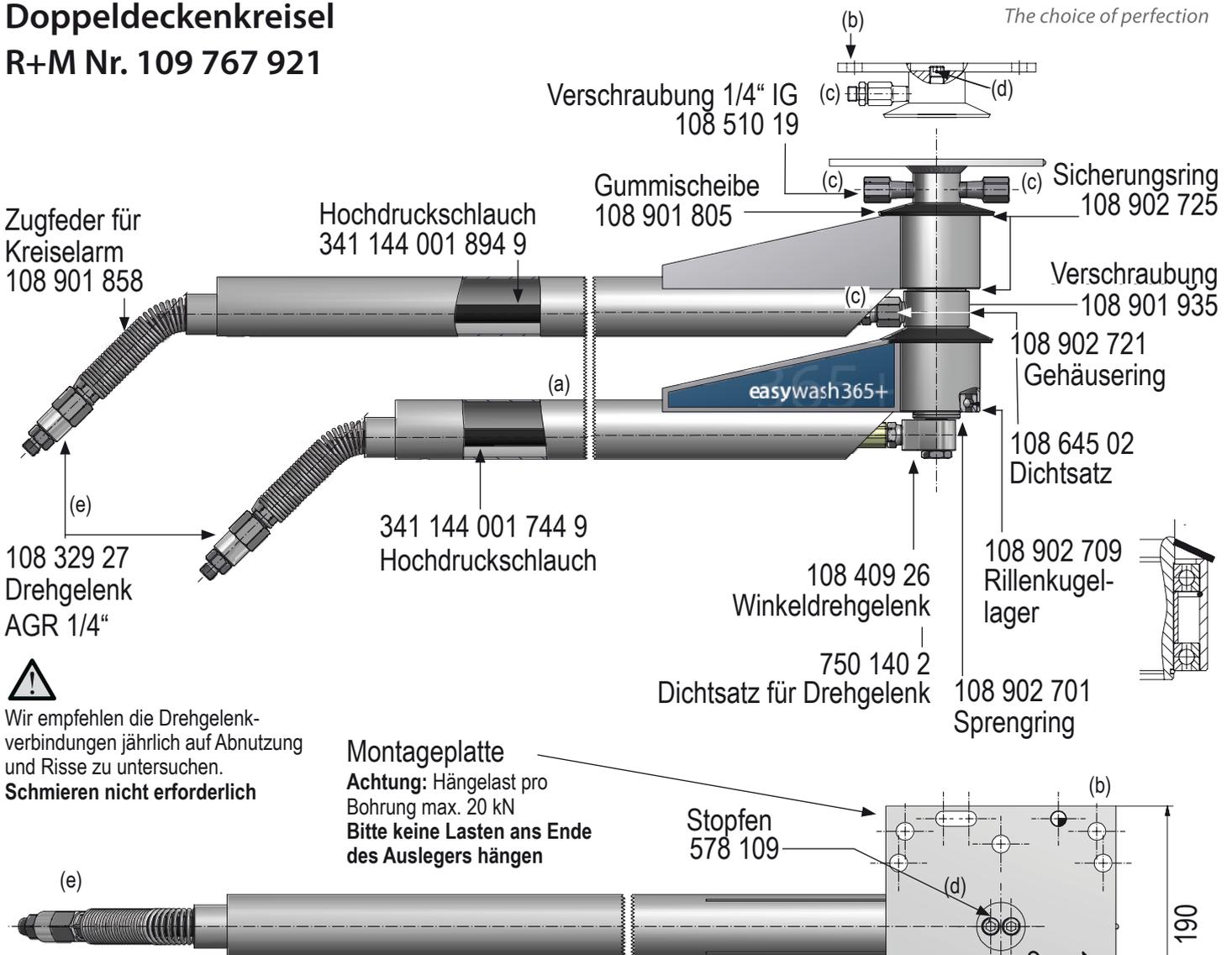
Wir empfehlen die Drehgelenkverbindungen jährlich auf Abnutzung und Risse zu untersuchen.
